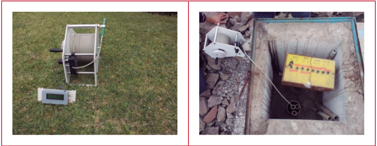
Ilustración 7.20 Aspectos de la sonda, cable y electrodo
