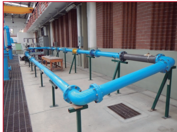
Ilustración 3.1 Arreglo experimental para evaluación de medidores con flujo de agua con sedimentos
