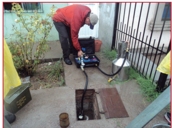
Ilustración 4.4 Medidor volumétrico empleado como medidor patrón para evaluar medidores de consumo
