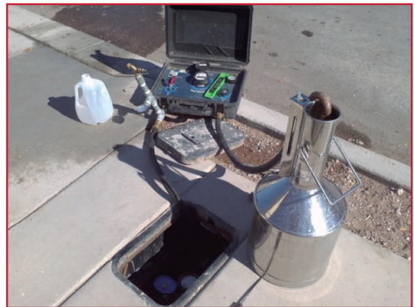
Ilustración 11.28 Proceso de prueba con la medida volumétrica captando el volumen que pasa por el medidor
