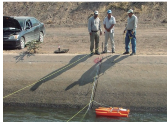
b) Arreglo de cuerdas y poleas para poder mover un PD en un canal profundo
