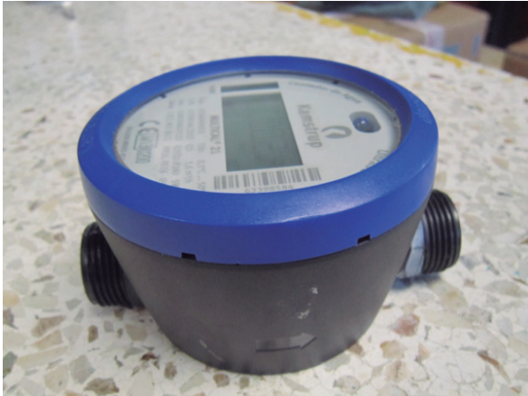
Ilustración 11.15 Medidores ultrasónicos domiciliarios
