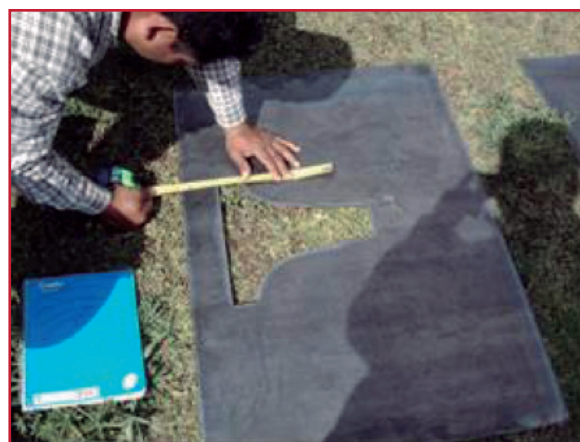
Ilustración 5.8 Inspección dimensional de vertedores
