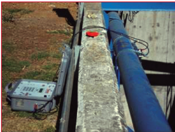
Ilustración 5.11 Proceso de Medición en múltiple de descarga con medidor ultrasónico
