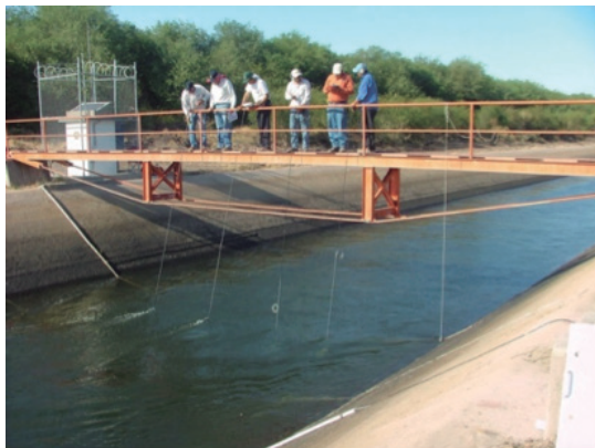
c) Ejemplo de campaña de aforos para calibrar un AD
