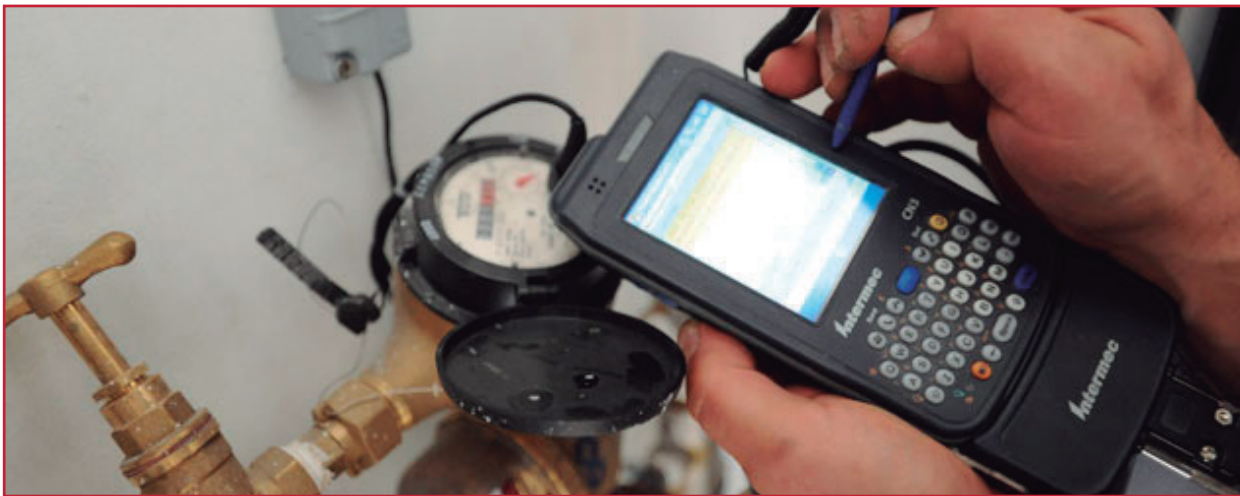
Ilustración 11.22 Terminal remota ( hand held ) para toma y registro de lecturas de consumo en medidores
