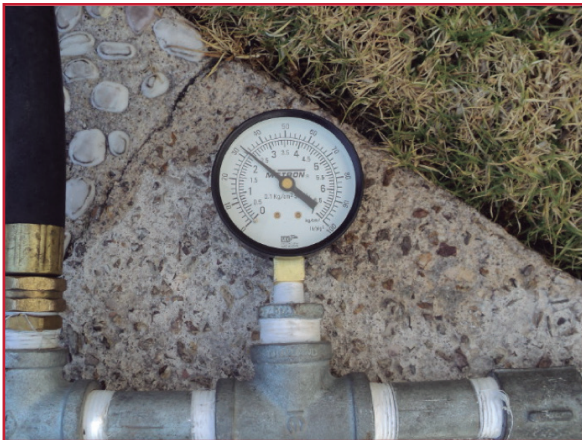
Ilustración 7.9 Instalación de manómetro tipo Bourdon
