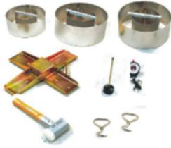
**Infiltrómetro doble anillo "Eij KelKamp" para realizar medidas sincronizadas triples de velocidad de infiltración. Equipo completo**
