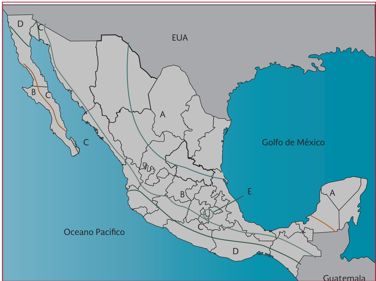
Ilustración 3.8 Zonificación del territorio mexicano para espectro de respuesta sísmico AASTHO
