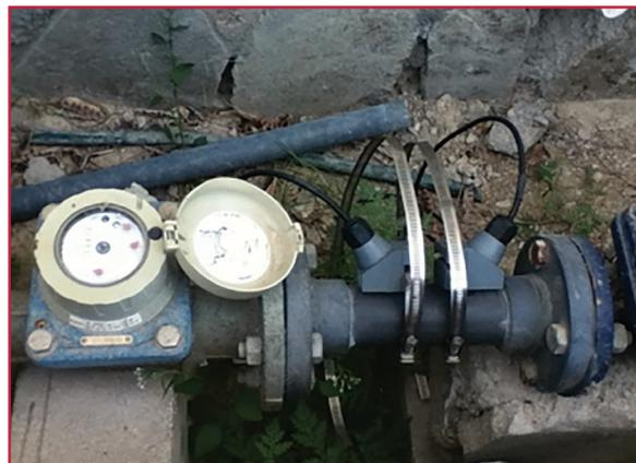
Ilustración 2.22 Ejemplo de auditoría de medidor. La medición del alto consumidor en cuestión, es confiable
