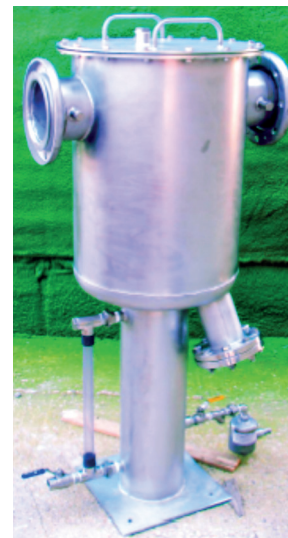
Ilustración 4.9 Filtro de grava
