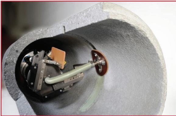
ción correspondiente a cada albañal, ya sea por medio de un robot (Ilustración 2.35d y e) o de forma manual por un operario
