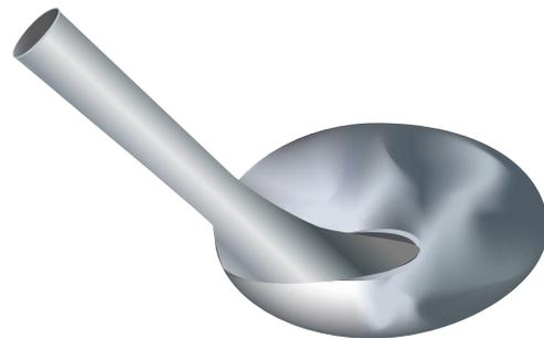
Al efectuar el empotramiento de la tubería de la conexión domiciliaria con la tubería de la atarjea, debe tenerse cuidado de no dejar filtraciones en dicho sector.
