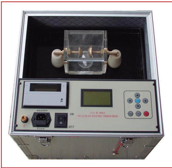
Ilustración 2.4 Prueba de rigidez eléctrica del aceite
