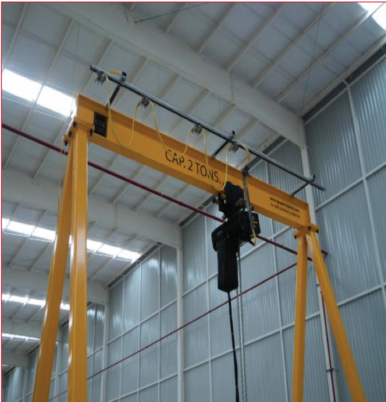
Ilustración 6.1 Ejemplo de grúa viajera manual
