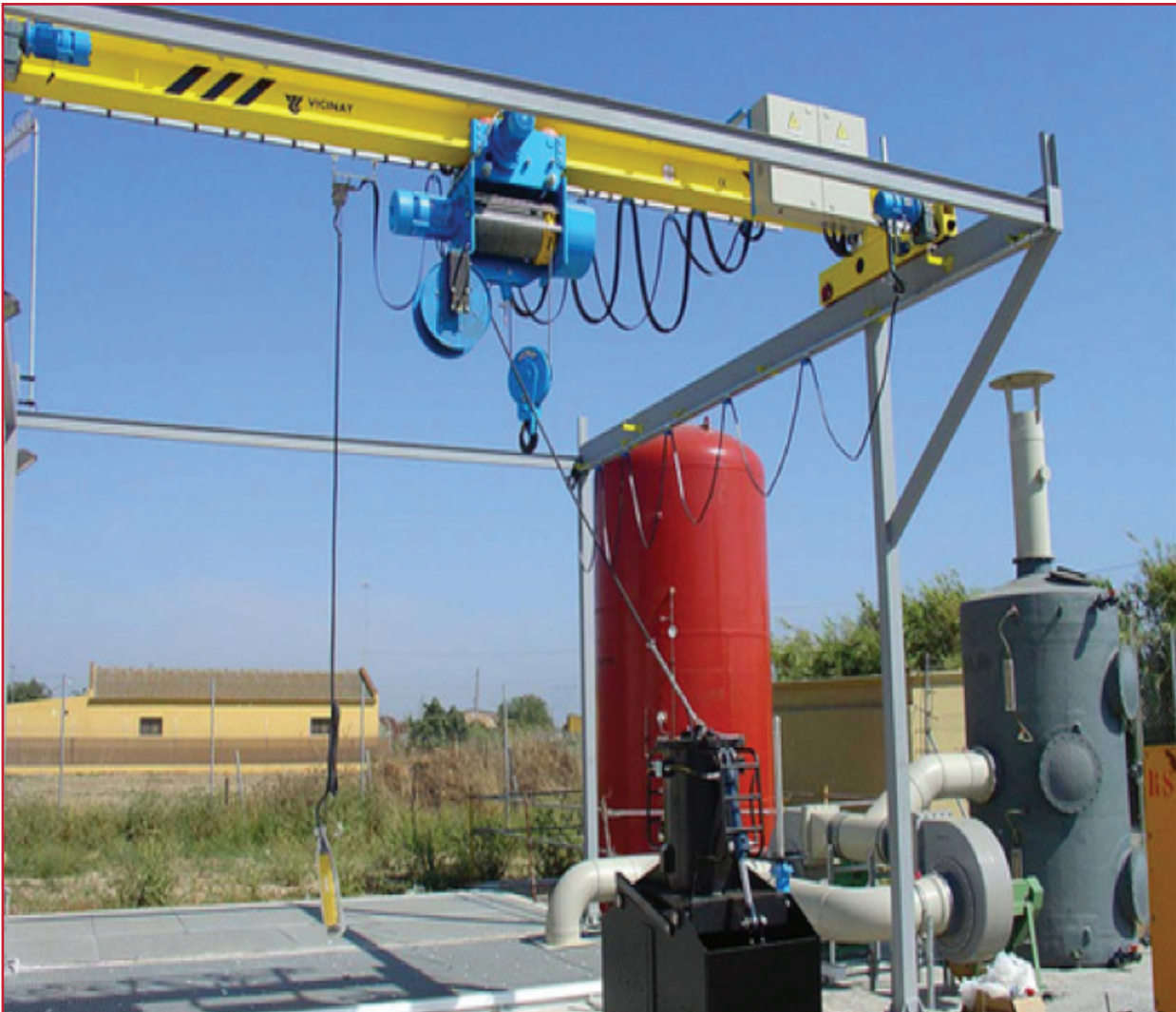
Ilustración 6.3 Ejemplo de grúa viajera eléctrica
