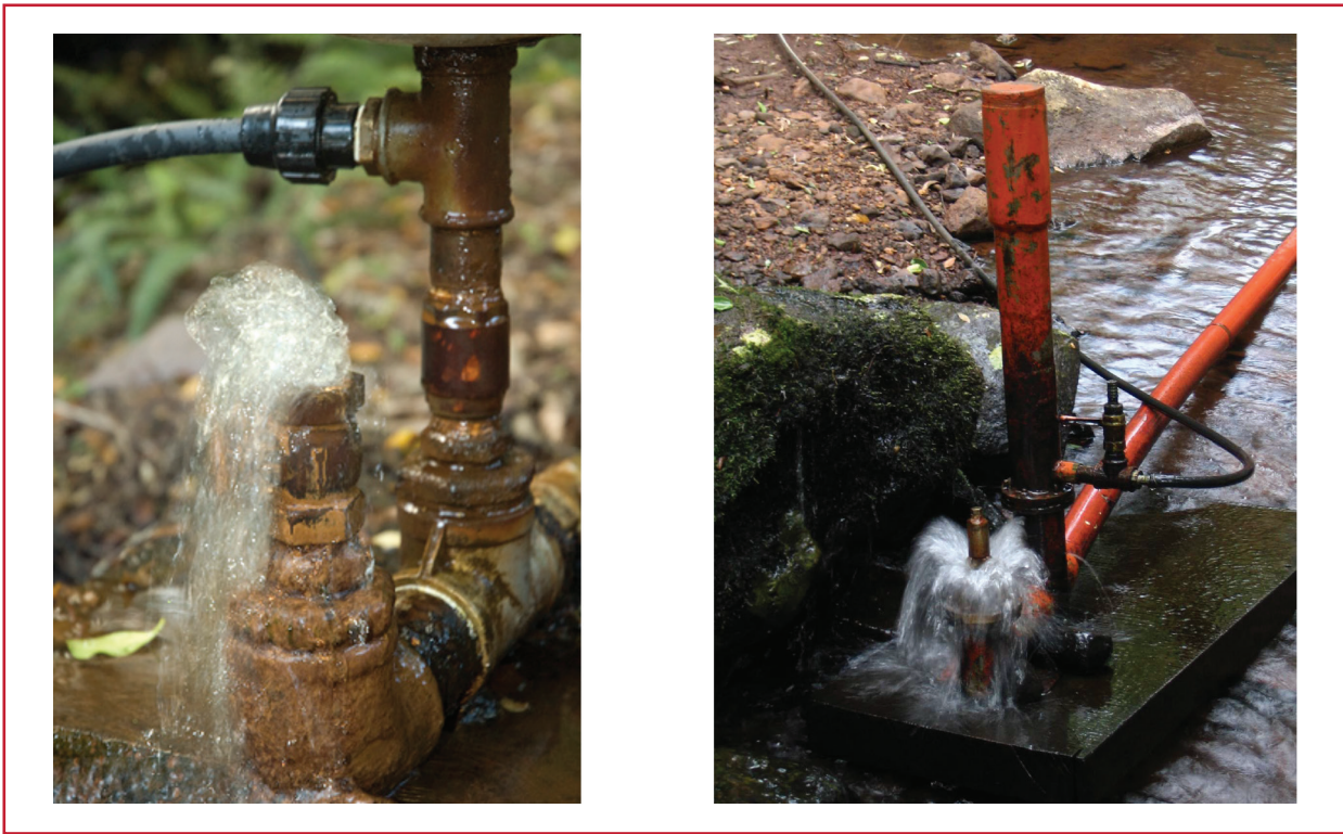
Ilustración 5.28 Esquema típico de una bomba tipo ariete
