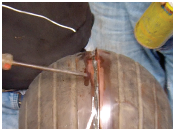
e) Sellado de la fisura en el flotador
