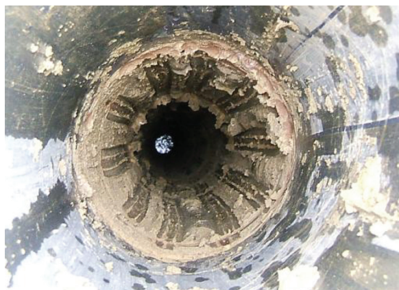
Ilustración 4.1 incrustación en pozo (Nitana 200, 2008)
