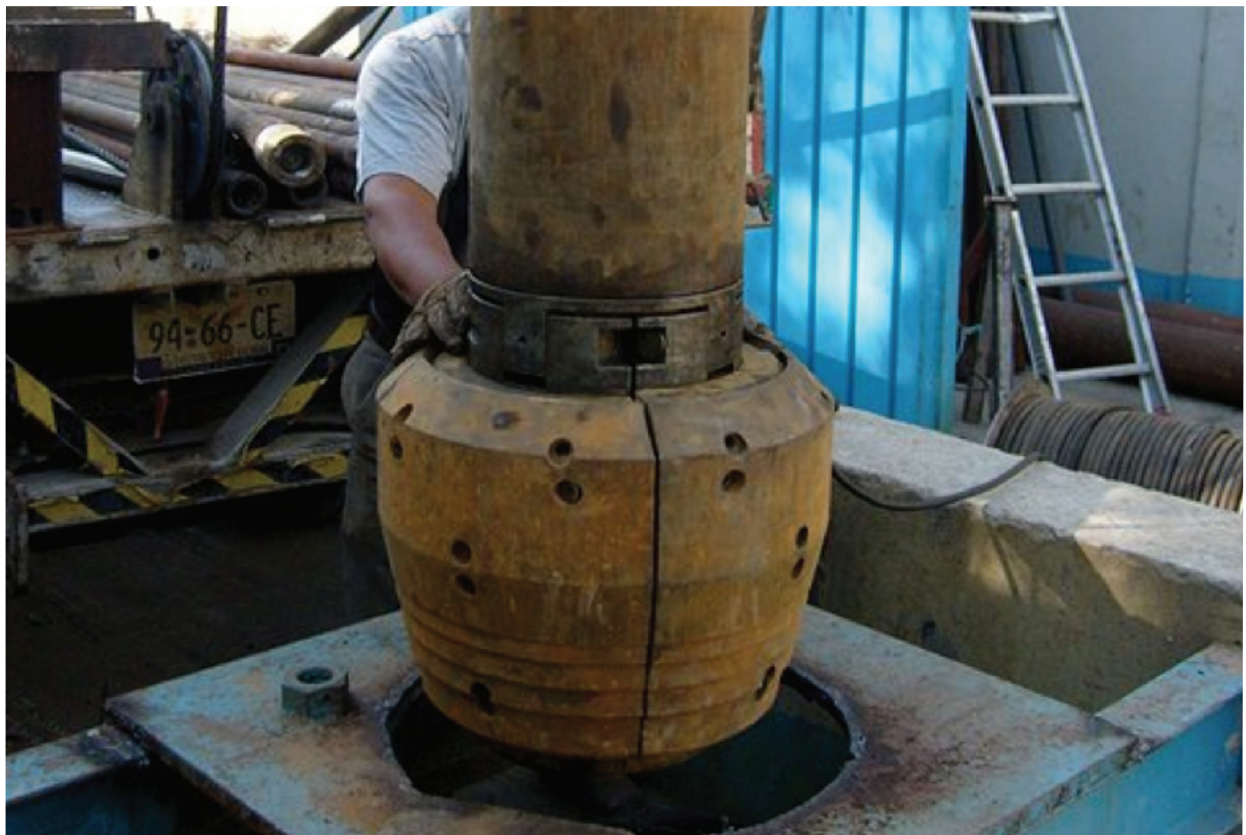
Ilustración 3.1 Trompo para rectificación de ademes
