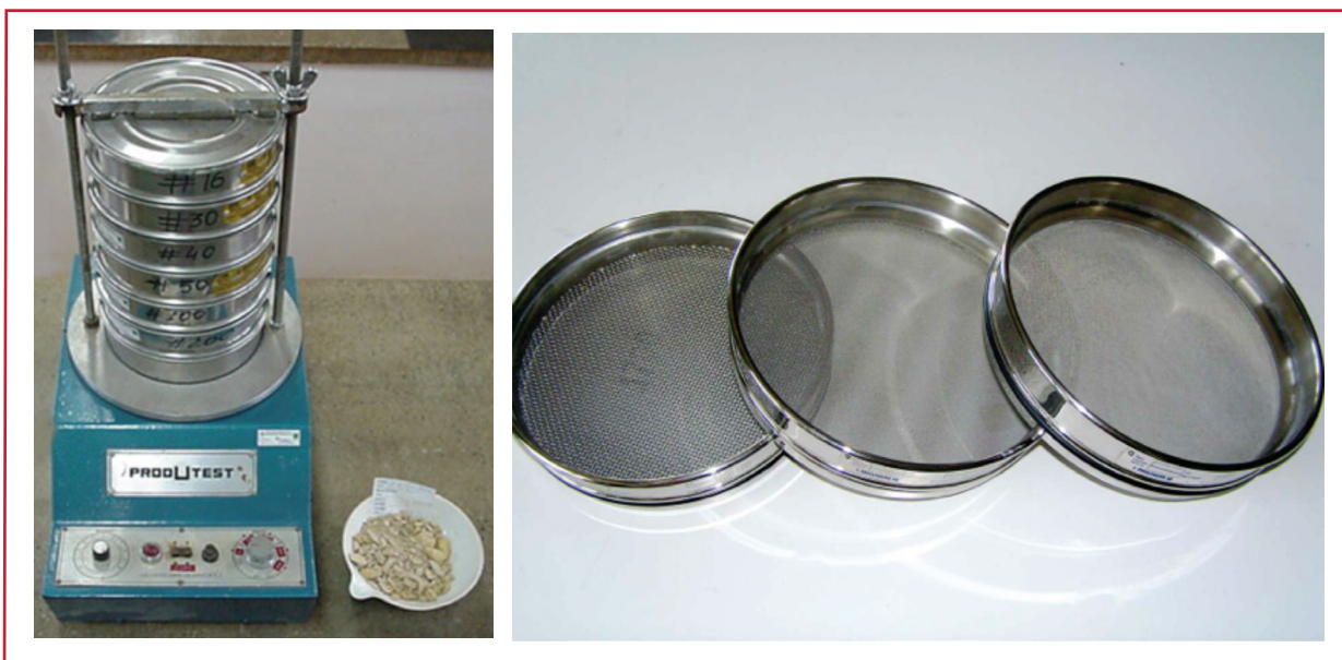
Ilustración 8.2 Cedazos para análisis granulométrico
