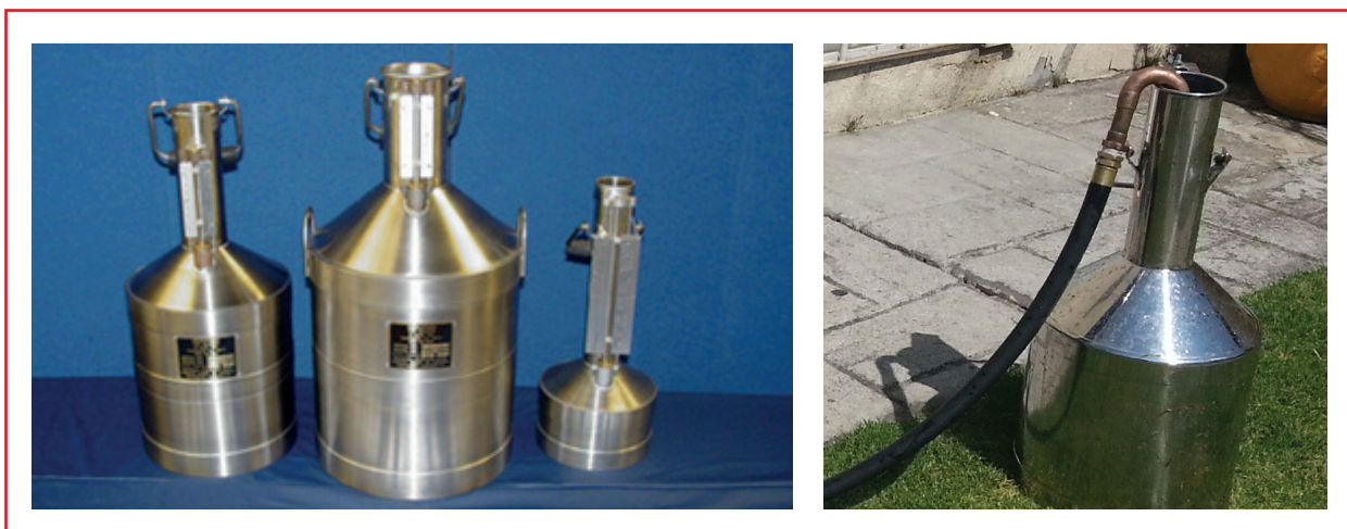
Ilustración 1.5 Equipo utilizado en pruebas de exactitud de micromedidores
