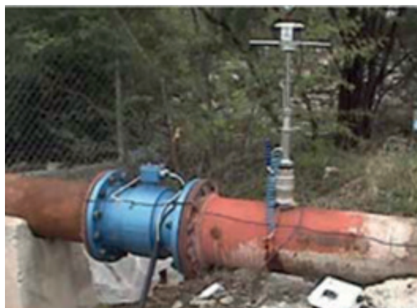
Ilustración 1.4 Medición de error de exactitud en macromedidor instalado (color azul), con medidor portátil electromagnético de inserción
