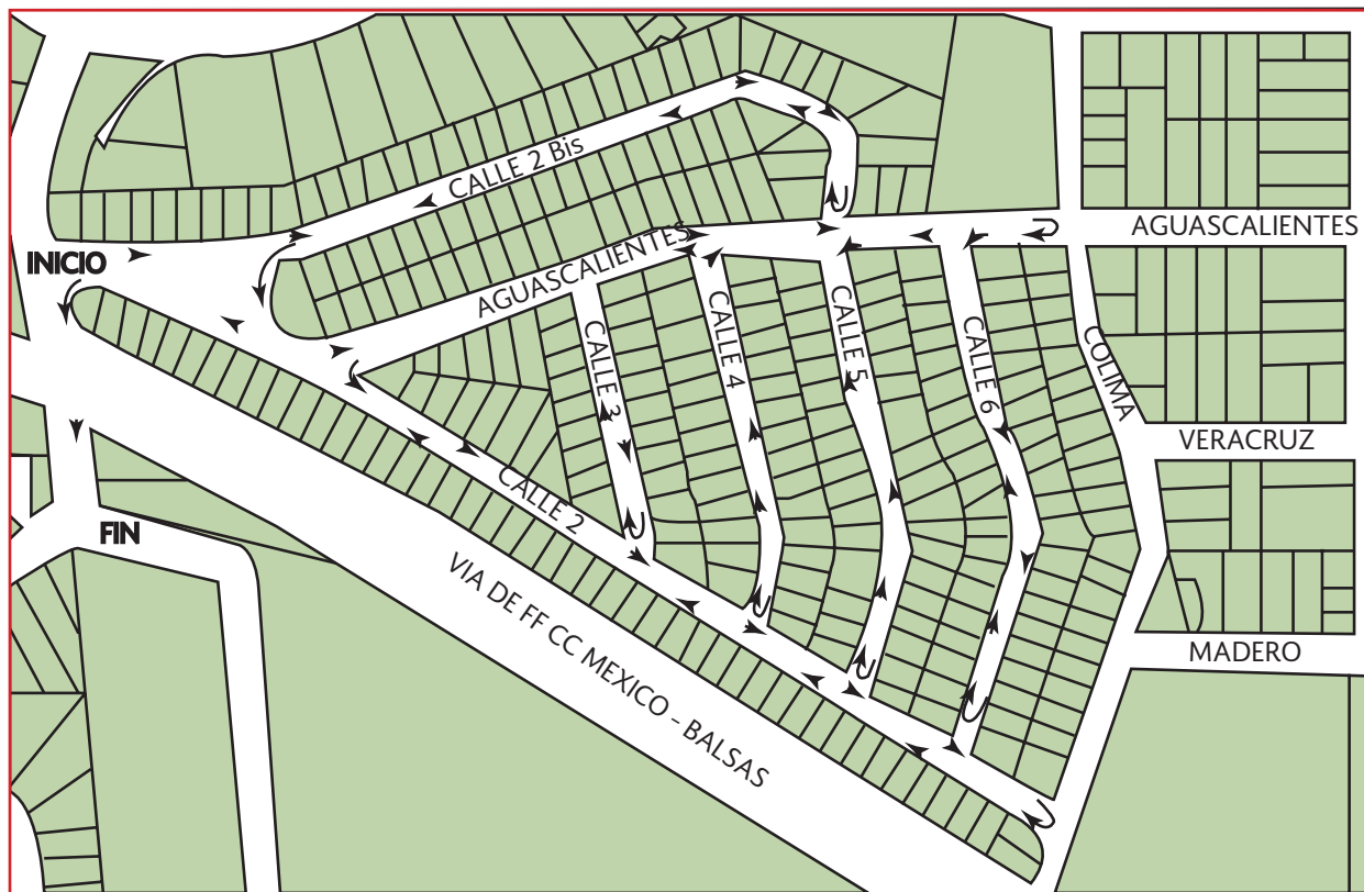
Ilustración 1.9 Croquis típico de recorrido para vinculación de tomas domiciliarias
