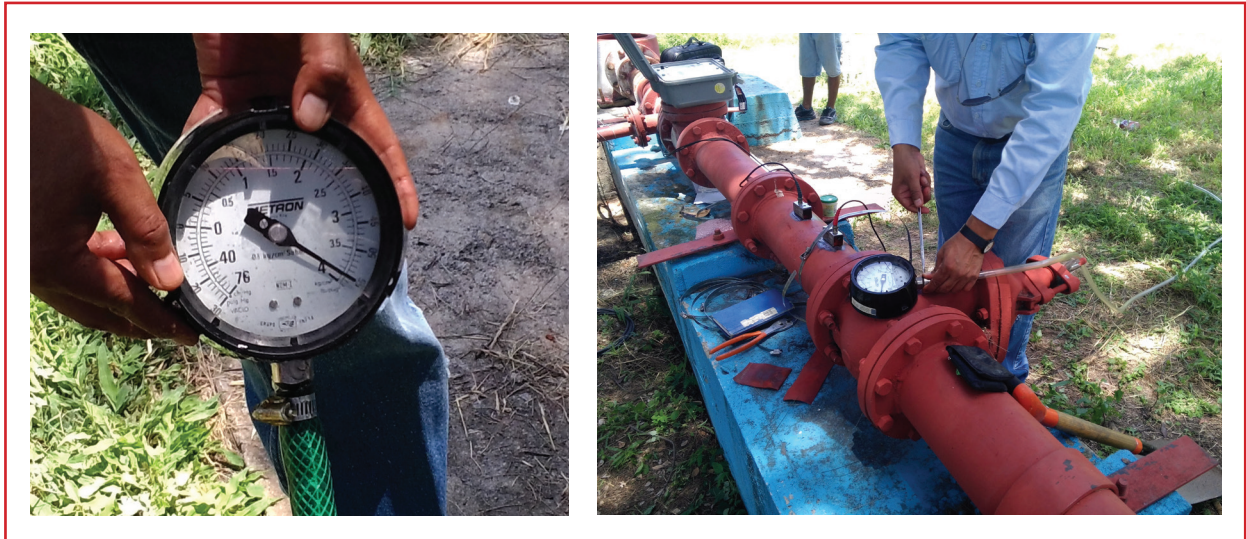
Ilustración 1.18 Medición de presión con manómetro tipo Bourdon calibrado
