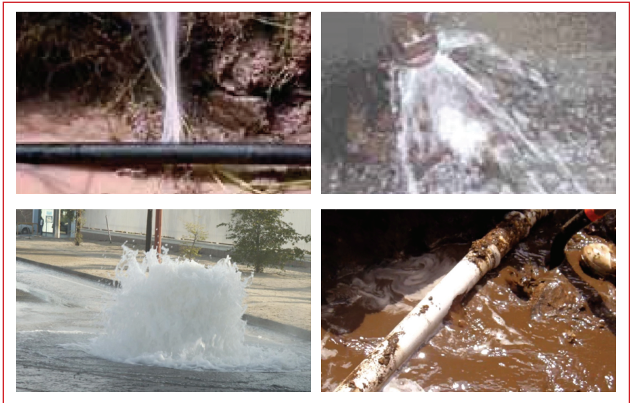
Ilustración 4.4 Fugas típicas en redes de agua
