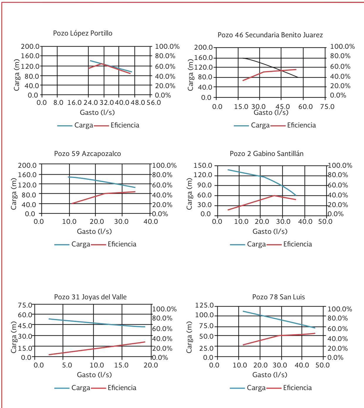
Ilustración 1.23 Curvas características reales H-Q en pozos de un organismo operador (continuación)
