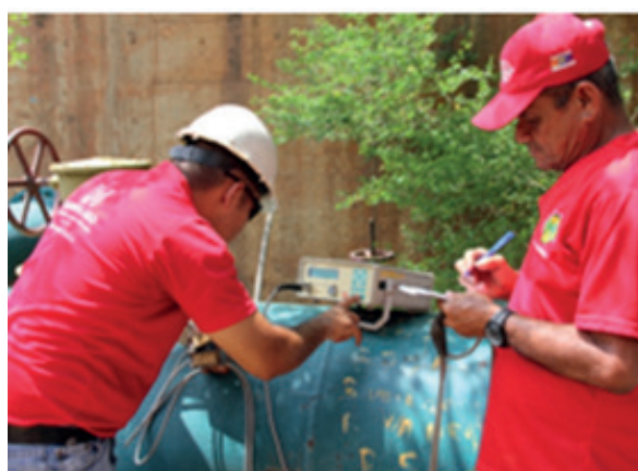
Ilustración 1.4 Medición de error de exactitud en macromedidor instalado (color azul), con medidor portátil electromagnético de inserción
