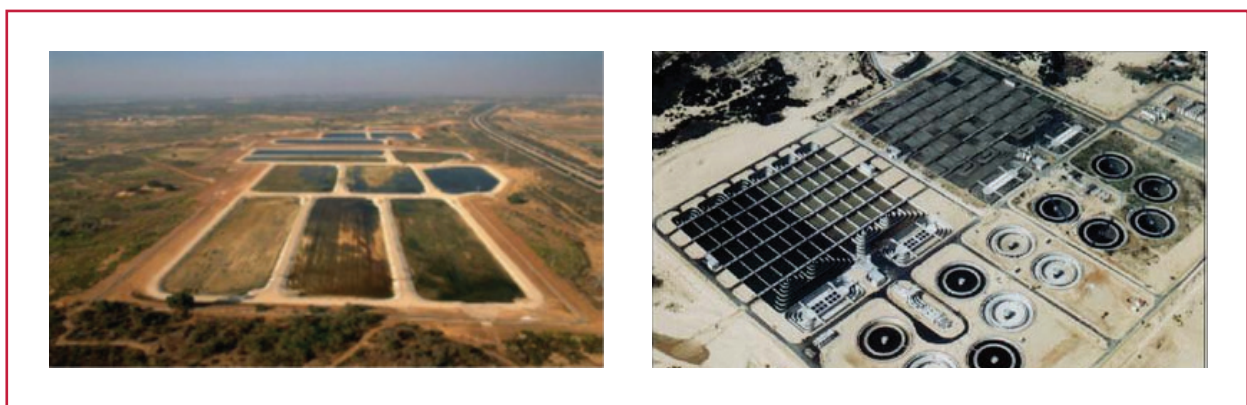
Ilustración 5.28 a) Los campos de infiltración de Shafdan en 1972 b) Actual planta de tratamiento de lodos activados (1996)
