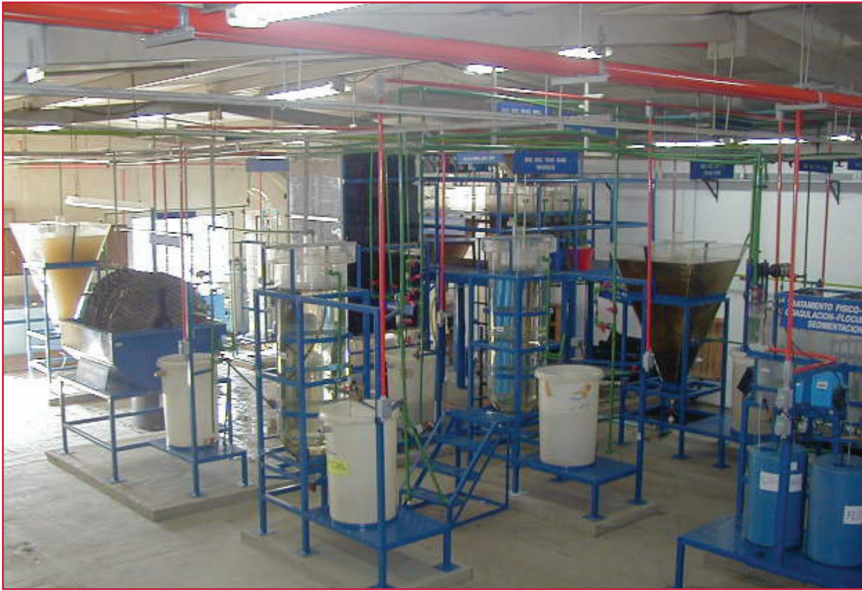
Ilustración 6.2 Trenes de tratamiento: a) Filtración y adsorción conectados en serie para el tratamiento del efluente secundario; b) Módulo para el estudio del tratamiento primario avanzado
