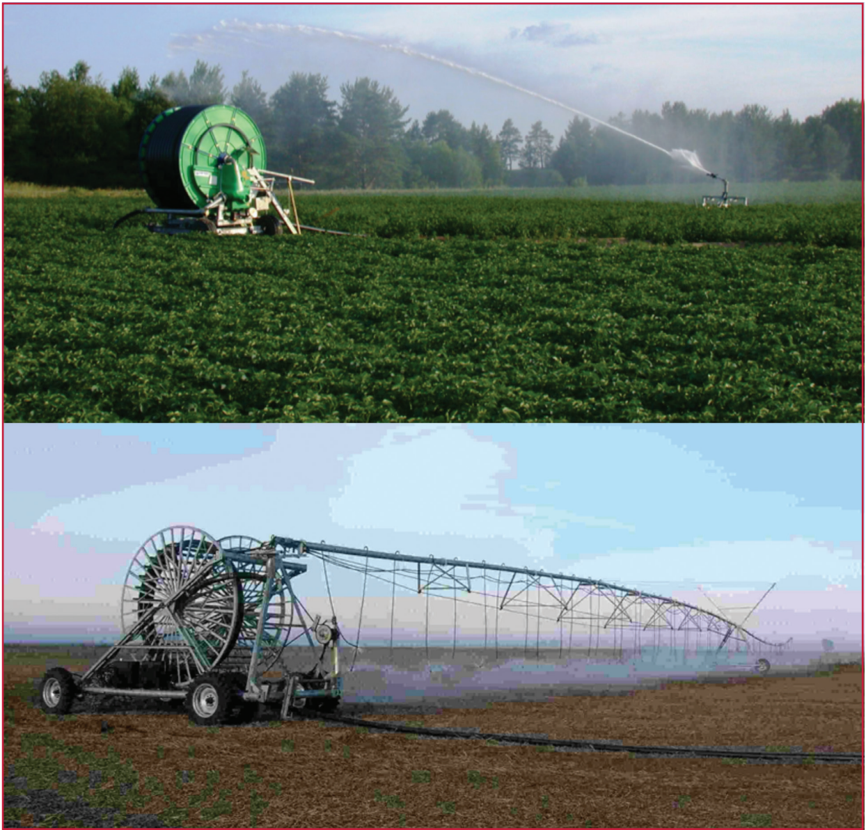
Ilustración 4.3 Ejemplos de riego móvil
