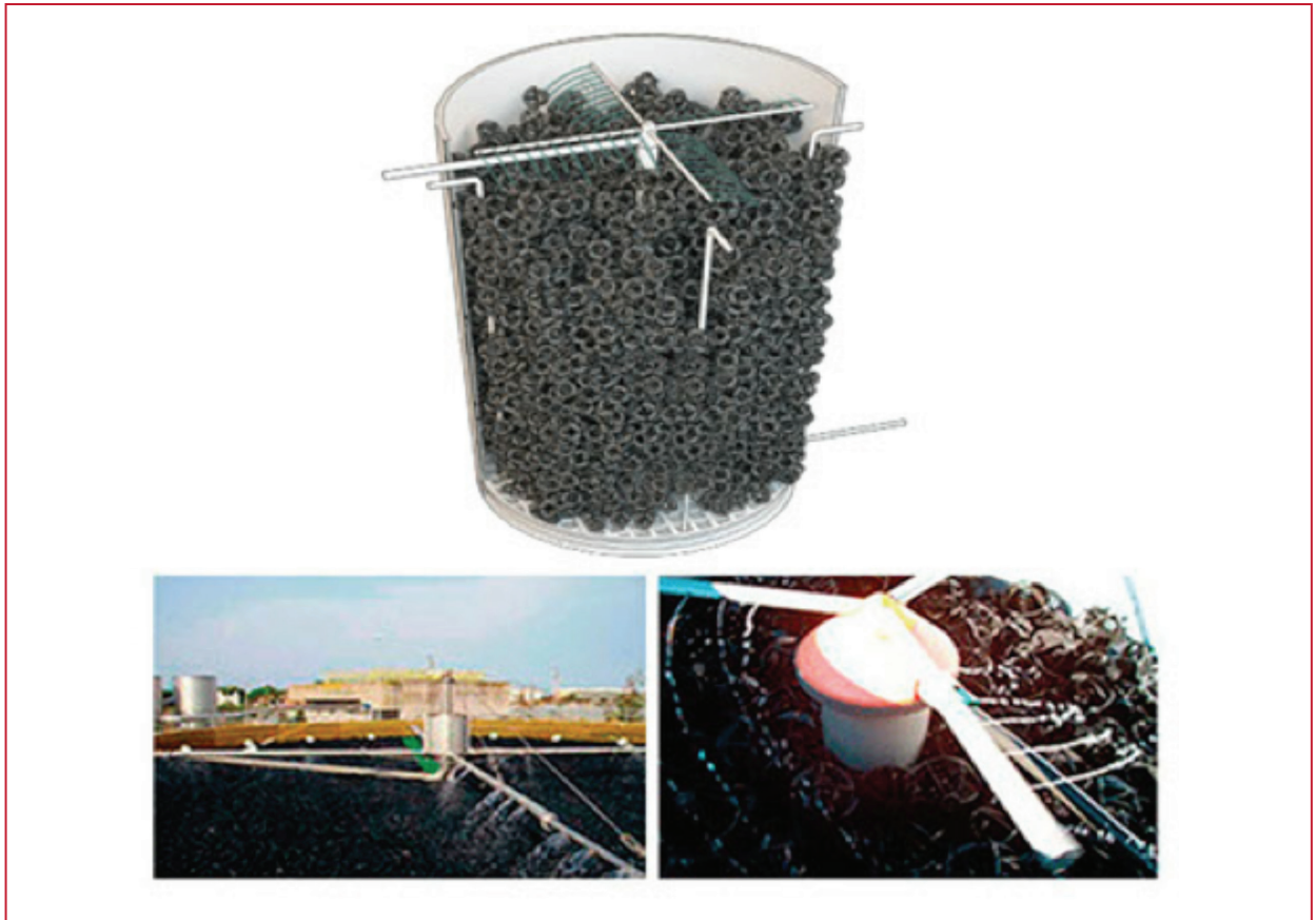
Ilustración 2.7 Medio de soporte de bloques de plástico
