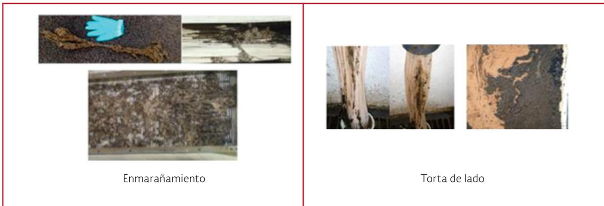
La presencia de MON soluble y suspendido permite la acumulación de este material en la superficie de las membranas y dentro de los poros (Nagaoka *et al.*, 1998, 1996; Mukai *et al.*, 1999; Chang y Lee, 1998).
