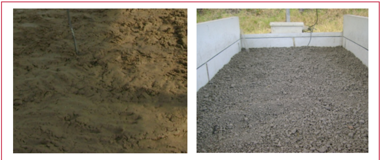
Ilustración 12.35 Secado solar de lodos industriales al aire libre. (Cardoso et al., 2007)
