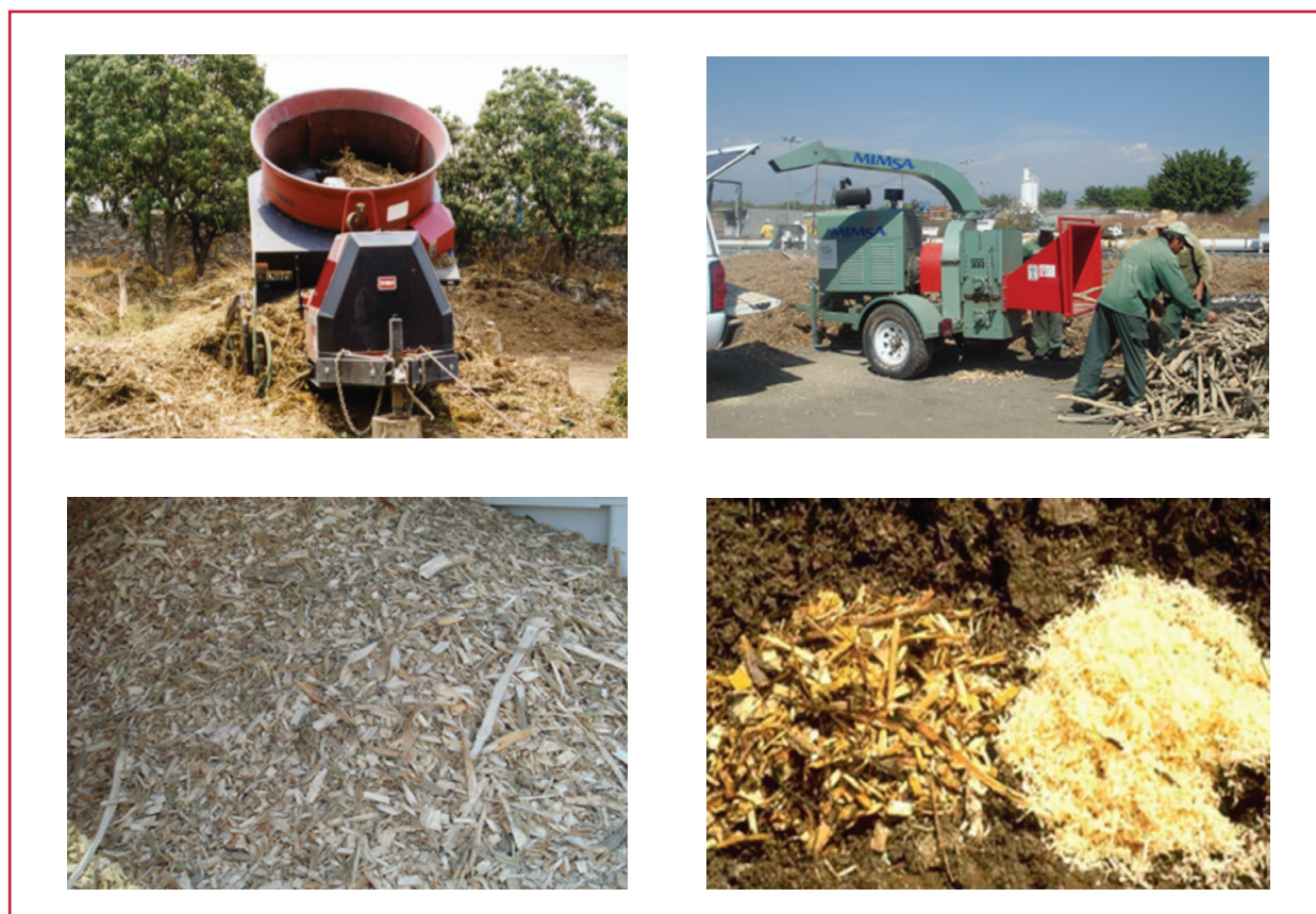
Ilustración 10.21 Tamaño y trituración de partículas para composteo y vermicomposteo
