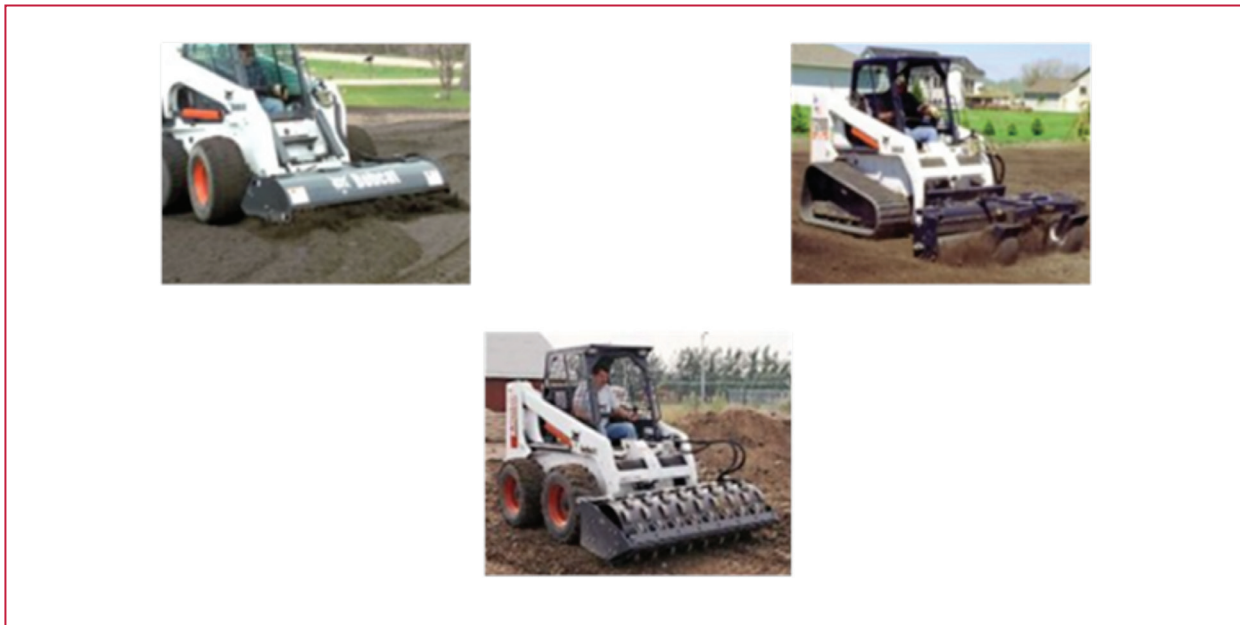
Ilustración 12.40 Cargador frontal con diferentes dispositivos que pueden utilizarse para el mezclado de lodo
