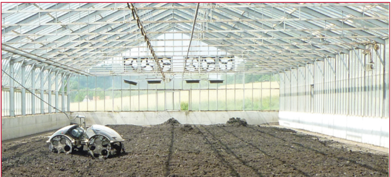
Ilustración 12.28 Sistema de secado de lodos, (Thermo-System, 2013)
