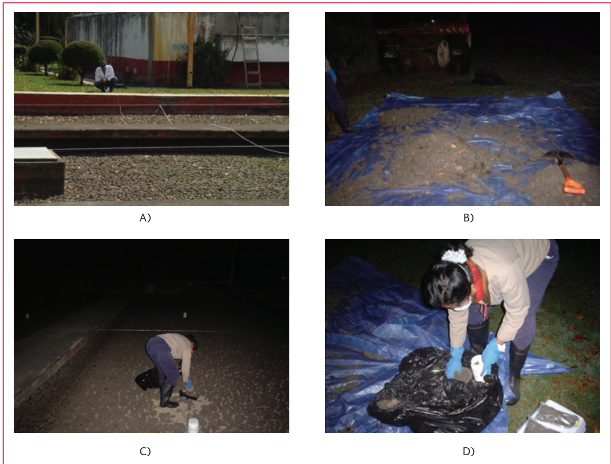
Ilustración 3.4 Muestreo de lodos en lechos de secado por el método del cuarteo
