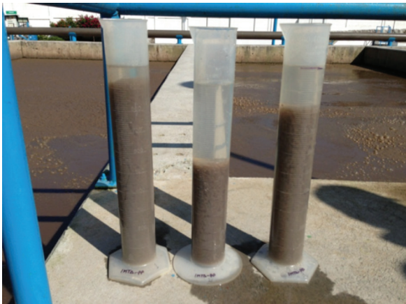
Ilustración 3.3 Lodo generado en el sedimentador secundario. Cortesía PTAR de Valle de Bravo
