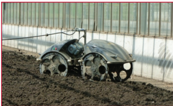
Ilustración 12.31 Carro eléctrico (Mole) para mover y secar el lodo, (Thermo-System, 2013)
