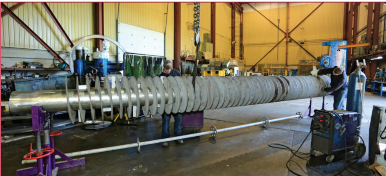
Ilustración 5.26 Mantenimiento de tornillo transportador
