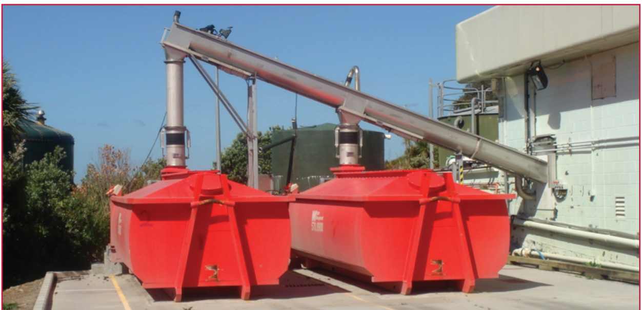
Ilustración 5.24 Aplicación del transportador de tornillo
