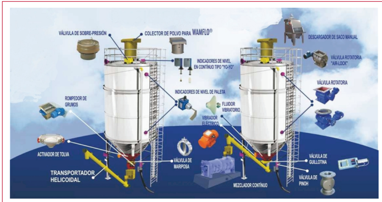
Ilustración 11.15 Componentes de un silo de almacenamiento de cal
