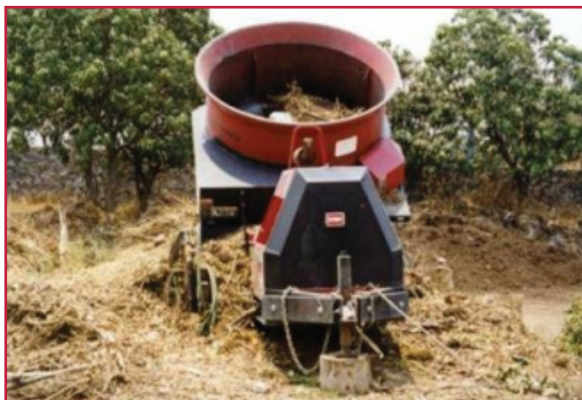
Ilustración 9.11 Picadora para el fraccionamiento del material acondicionador
