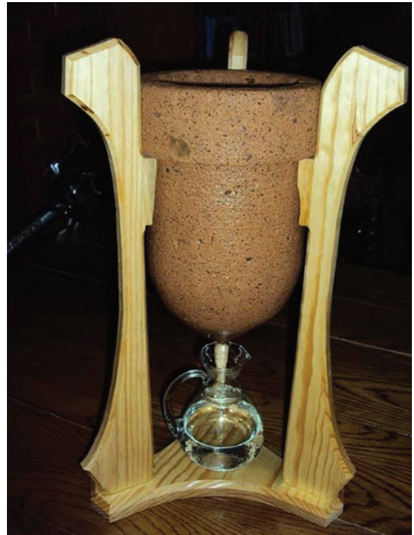
Ilustración 3.5 Filtro artesanal de cantera (cortesía de la empresa Agua Viva)
