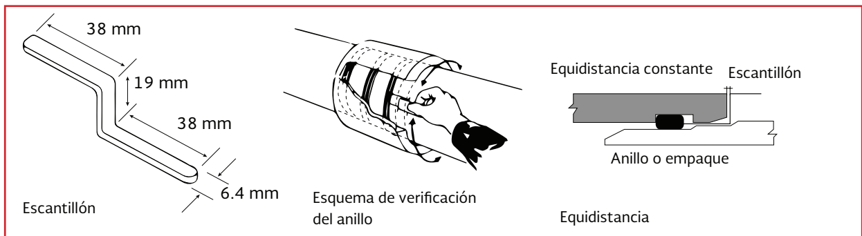
Ilustración 5.18 Instalación de tubería de concreto
