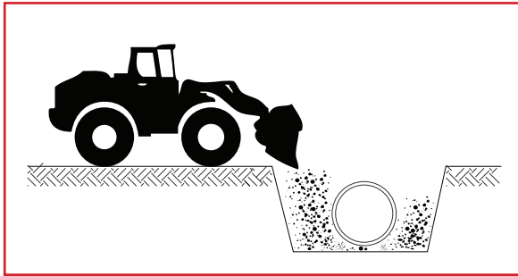
Ilustración 5.24 Proceso de relleno inicial de la zanja
