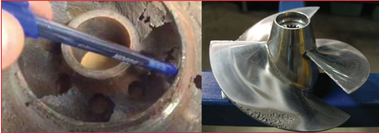
Ilustración 4.14 Daños de cavitación en bombas
