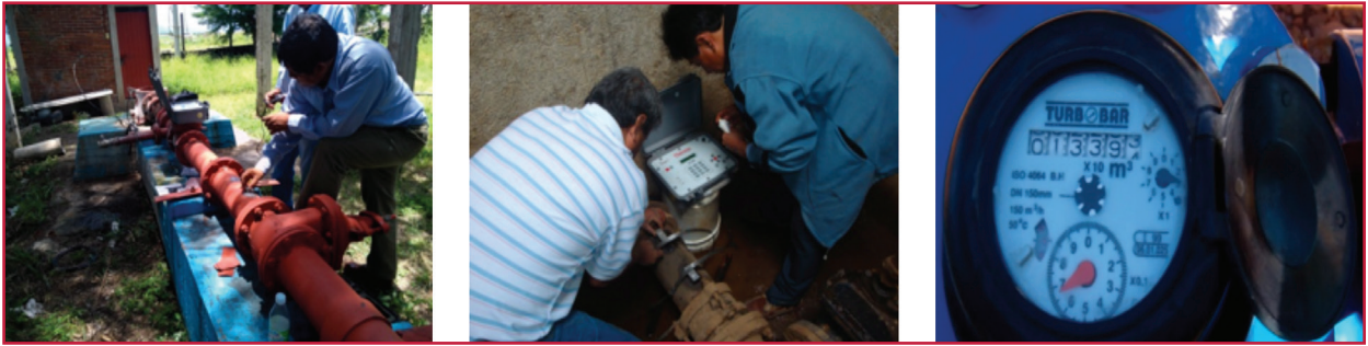
Ilustración 3.17 Mediciones de flujo en fuentes de abastecimiento
