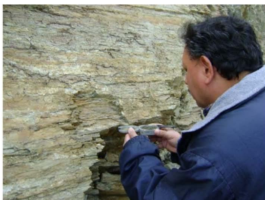
Fotografía 7.5.4d. En la presente imagen se aprecia cómo se obtuvieron los ángulos de buzamiento y echado de los estratos presentes en la zona de estudio.
