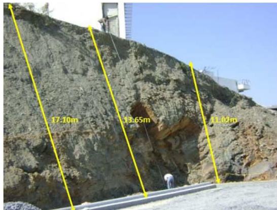
Fotografía 7.5.7.2.1a. Medida en campo de la altura.
