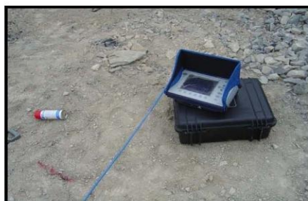
Fotografía 7.8.1.5.1. Monitor del georadar SIR 3000.
