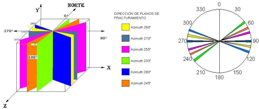
7.5.6.3.1d. Representación gráfica de fracturamiento en cadenamiento 0+030.
