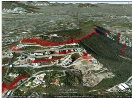
Figura 3. 3. 4. Cerro de La Corona. Exposición de pendientes con peligrosidad muy alta (> de 45°).
