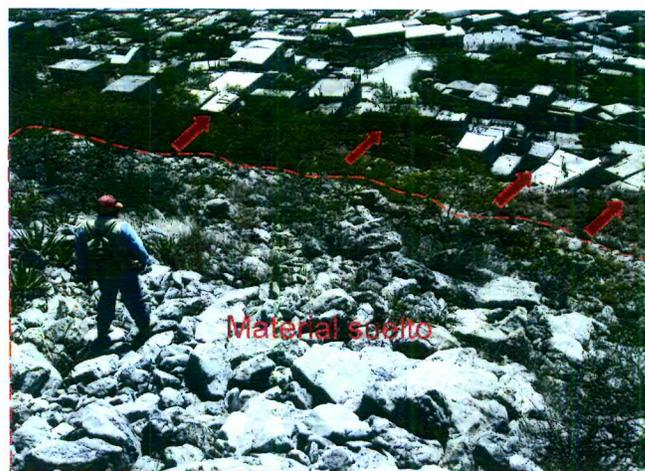
Fotografía 6. Indica el sentido de derrumbe de material suelto que se encuentra en una pendiente de 55%. (Amenaza a numerosas viviendas)
